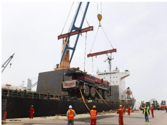
タンデムオペレーション (クレーン 2 基)
